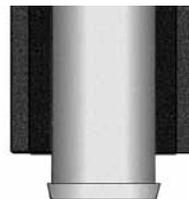
1. Nachdem die Transportsicherung entfernt wurde und das geschosshohe Element ca. 50 cm über dem darunterliegenden Element hängt, überprüfen Sie die werkseitig aufgeklebte Gewebedichtung.
