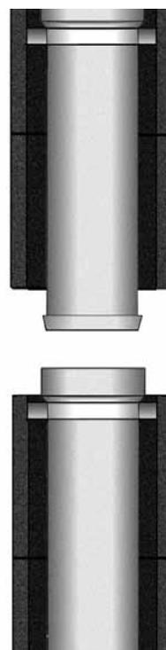
2. Den Mantelstein des bereits vorgefertigten Schornsteins mit Dünnbettmörtel bestreichen und das folgende Schornsteinelement langsam ablassen. Das Edelkeramik-Muffenrohr mit der Gewebedichtung muss beim Ablassen in die Muffe eingeführt werden.
