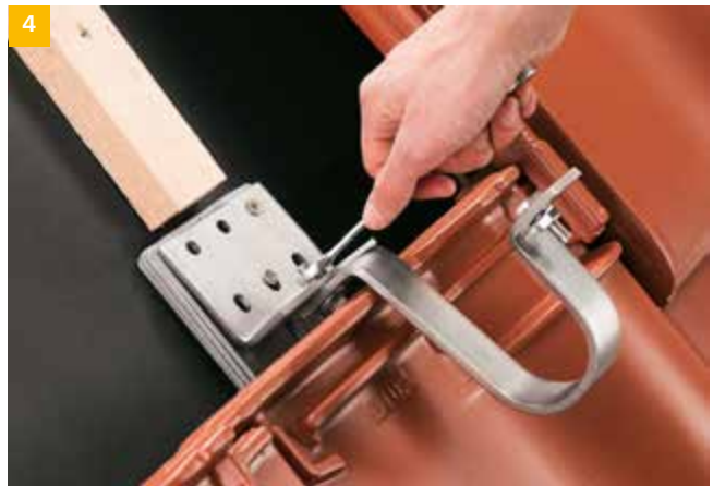
Bei Dachziegeln mit hohem Kopffalz oder stärkeren Latten kann die Höhe durch Distanzplatten oder anderweitige Unterleger sichergestellt werden.
