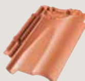
Ergoldsbacher Hohlfalz SL ohne Ausschnitt verwendbar bei Lattweite größer 34 cm
