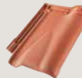
Ergoldsbacher E58 PLUS® ohne Ausschnitt verwendbar bei Lattweite größer 42 cm
