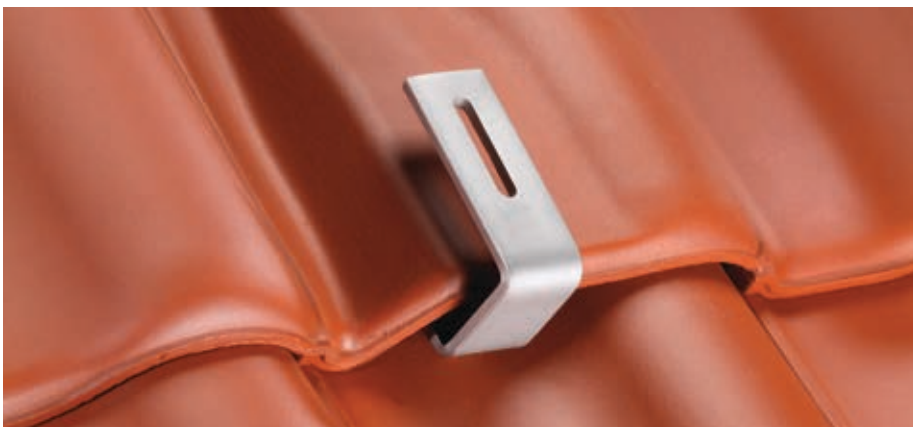
4. Lüfterziegel aufdecken. Hierauf können die Trägerschienen mit 8 mm Schrauben befestigt werden.
